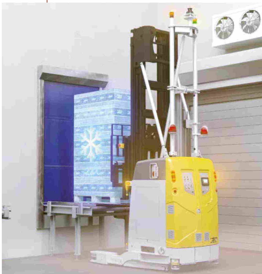
Magazzino automatico ad alta densità integrato da LGV
