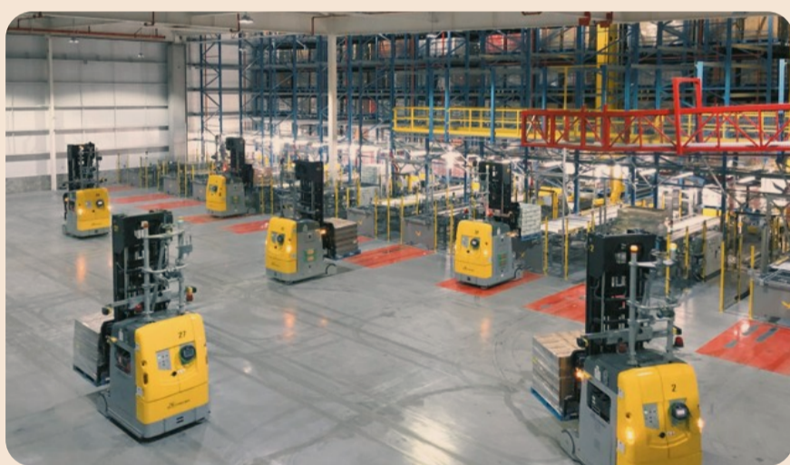
La gestione integrata di un Magazzino Automatico ad alta densità con Veicoli a Guida Laser
