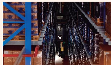
**AS/RS Stacker Crane** destaca por el uso de transelevadores equipados con dispositivos automáticos de manipulación de los productos en un almacenamiento de una, dos o varias profundidades. Las grandes alturas que se pueden alcanzar, superiores a los 40 metros, permiten incrementar la capacidad de almacenamiento en la misma unidad de superficie.
